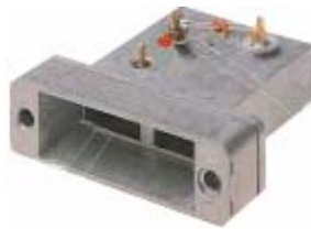
Şekil 15 10 m çalışma aralığına sahip mikrodalga X bant doppler modülü
