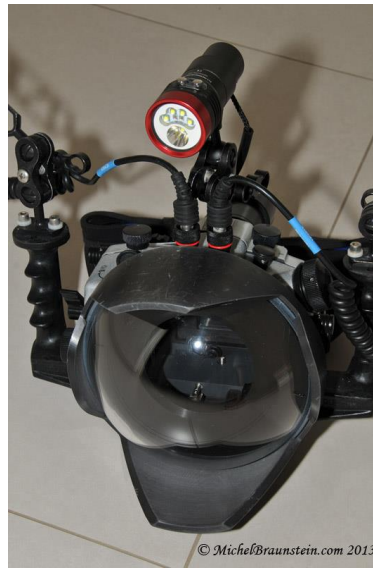
Fotoğraf 172: Kabine monteli 'netleme için yardımcı ışık' (FIT 2400)
