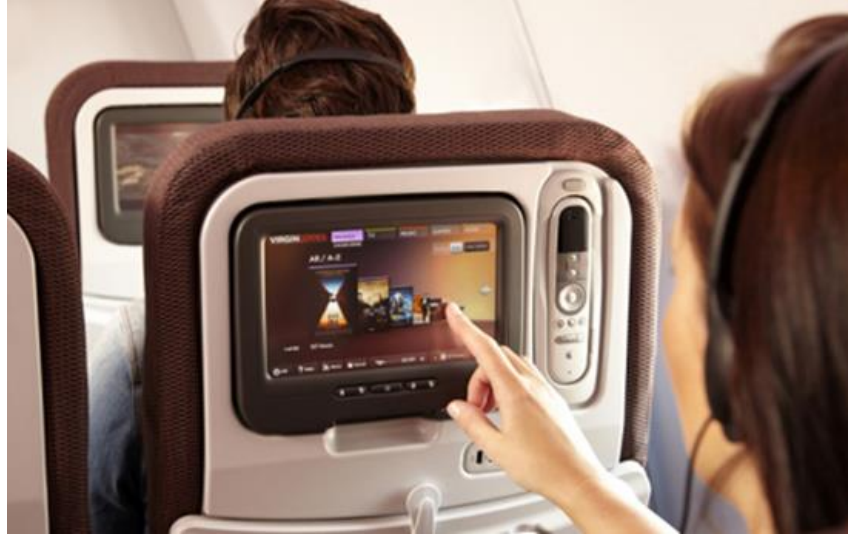
Şekil 4.35. Boeing Model 777-200, -300, -300ER serisi için tasarlanmış olan Economy Class koltuklarının eğlence sistemi
