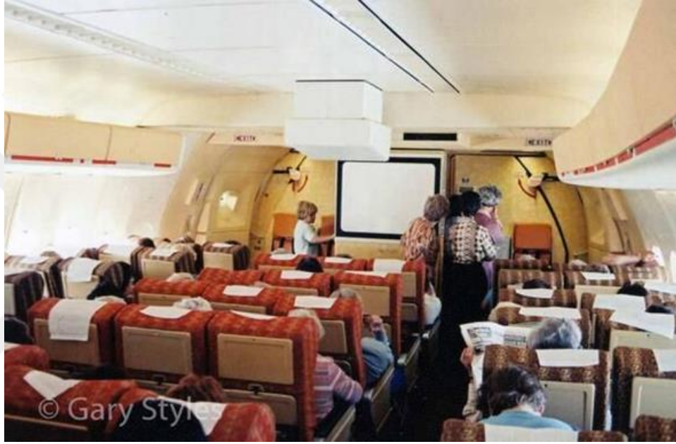
Şekil 2.66. Kabin içi kişisel eğlence sistemleri tasarlanmadan önce uçağın ön kabin panelinde dev bir ekran bulunmaktaydı. McDonnell Douglas DC-10
