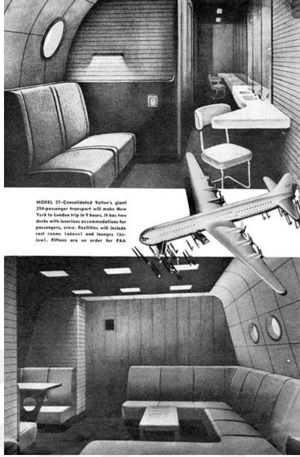
Şekil 2.24. Henry Dreyfuss tarafından tasarlanan Model 37’de tıpkı gemilerdeki gibi lumboz denilen pencereler kullanılmıştır.
