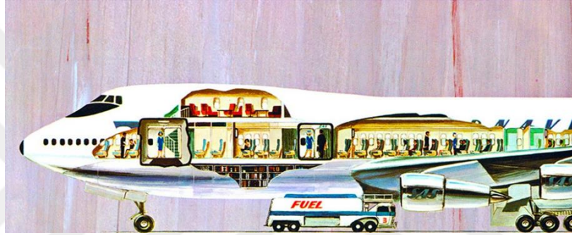
Şekil 2.63. B747'nin kesiti. Üst kat kokpitin hemen arkasında bulunuyordu
