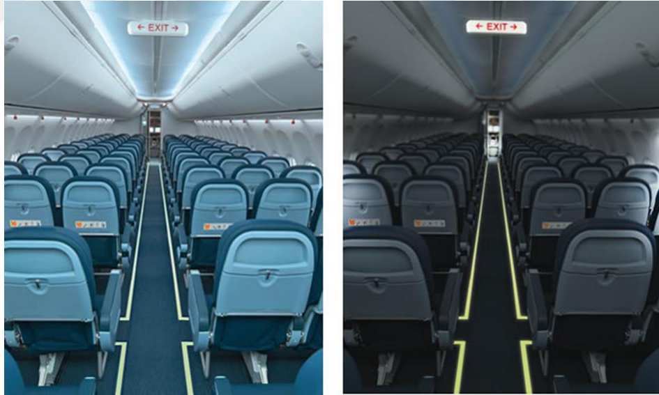
Şekil 4.27. Acil bir durum esnasında kendinden gün ışığında şarj olabilen ve yolcuların tahliyesini kolaylaştıran pad light aydınlatmalar (zemin aydınlatmaları) ( http://www.boeing.com/commercial/aeromagazine/articles/2011_q4/2/05.05.2016 )
