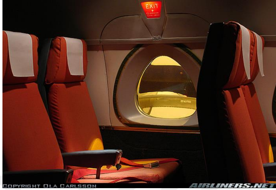
Şekil 2.51. Caravelle'nin alışılmışın dışında tasarlanan damlacık şeklindeki pencereleri, acil durumlarda yolcuların daha hızlı tahliyesi için kullanılan acil çıkış penceresi
