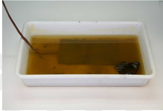
Resim 106: Oyulmuş Levha ve Çelik Tel İçeren Tank
