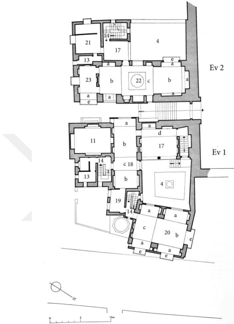
Görsel 99. Gayer Anderson Müzesi-Kat1(Revault ve Maury, 1979: s.63) - Evi ElQa'a, Mkad ve harem ilişkisi. 17- Mkad 17a- Sedelle 17d- Geçiş yolu 18- El Qa'a- Selamlık 19- Ara oda 20- El Qa'a harem alanı a- Sedelle b-İwan c- El Dorkaa e- Maşrabeya 21- Oda 22-El Qa'a 23- Dinlenme odası
