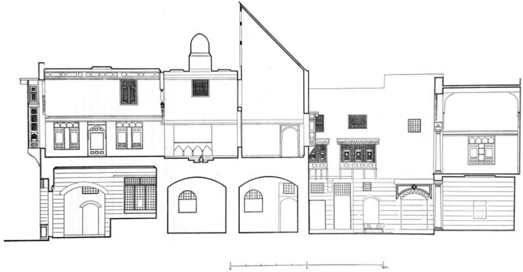
Görsel 156. El Senary Evi- Mkad, Üst el Qa'a'yi ve ona ait Malkaf- şöşsha- saffa- Maşrabeya gibi öğeleri gösteren kesit (Revault ve Maury, 1979: s. 98)
