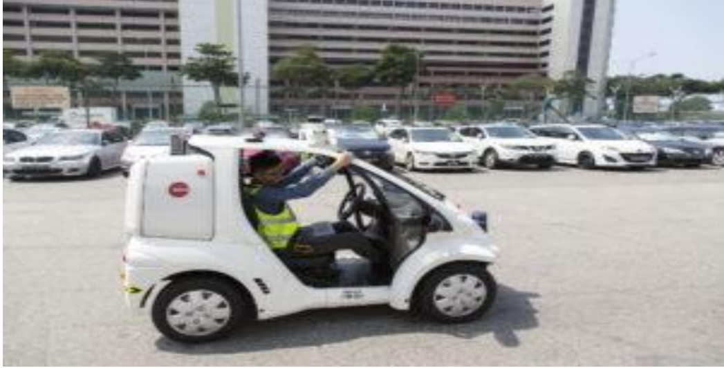
Şekil 3. Otomatik Hava Kargo Evrak Taşıma Aracı
