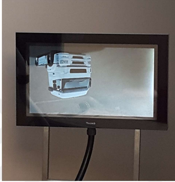
RESİM 29: fMRI Cihazının İçinde İken Katılımcıya Uyarın Görüntülerini Gösterebilmek Üzere Kullanılan, Manyetizmadan Etkilenmeyen ve Ters Ayna Düzenegi ile Uyumlu Görüntü Yansıtılmış Ekran.
