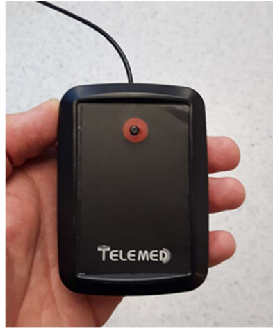
RESİM 27: Katılımcıların Uyarılara Karşı Cevaplarını Vermek Üzere Kullandıkları, fMRI Cihazı ve Özel Tasarlanmış Ekran ile Senkronize Çalışan El Butonu.
