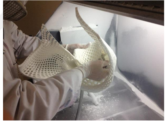
Resim 14: Francis Bitonti Studios, Dita von Teese Dress, 2013. Dikişsiz elbise, malzemenin lazerle kaynaşmış plastik tozdan katmanlar halinde oluşturulduğu seçici lazer sinterleme (SLS) kullanılarak yapılan 3000 benzersiz hareketli parçadan yapılmıştır ( https://www.dezeen.com/2014/02/14/moviefrancis-bitonti-dita-von-teese-3d-printed-dress/ erişim: 30.06.2020).
