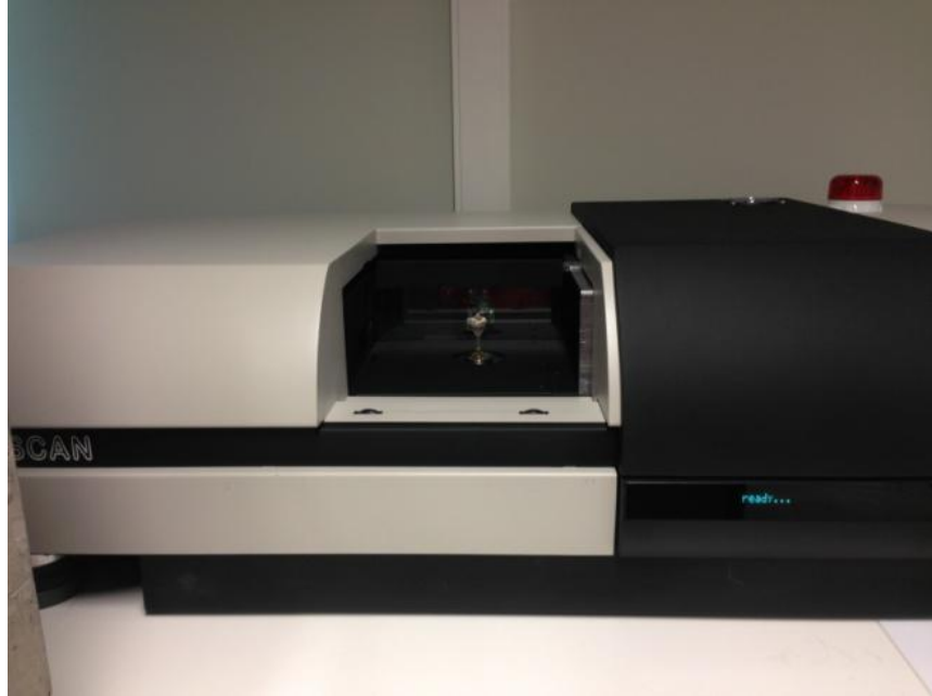
Şekil 3.7: Mikro-BT cihazına örneklerin yerleştirilmesi
