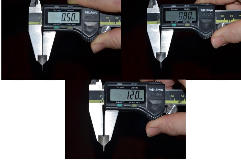
Resim 4. Dijital kumpas yardımıyla örneklerin son kalınlıklarının ölçümü
