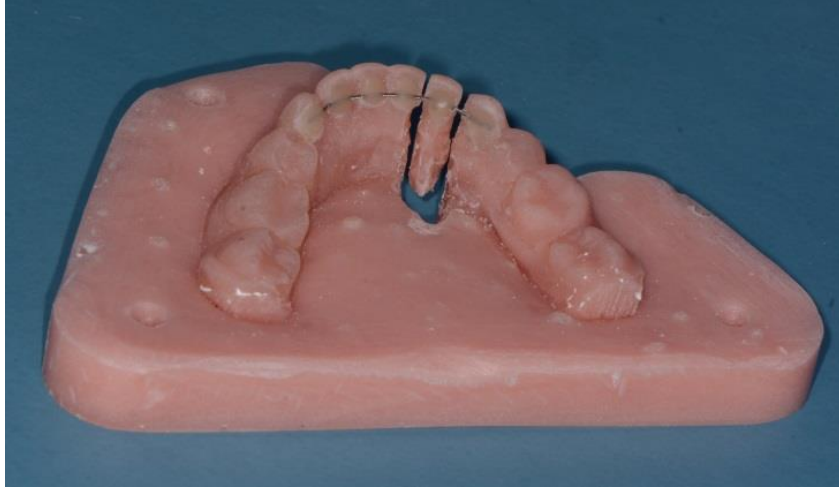
Resim 17. Yer deęiřtirme testi için Pent-one® tel yerleřtirilmiř numunelerden birinin lingual taraftan grnm
