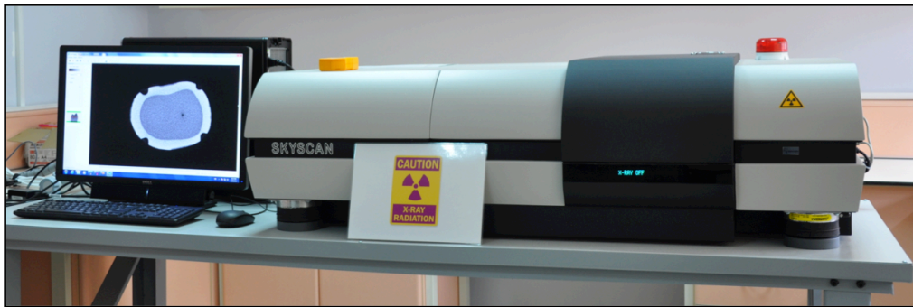
Resim 5.7. Deneyde taramalar için kullanılan Skyscan 1172 Mikro-BT sistemi
