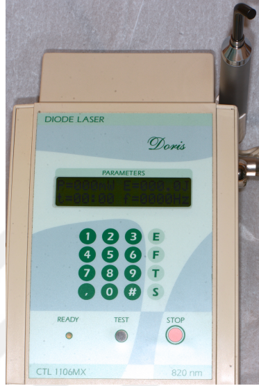
Resim 5.5. Çalışmamızda kullanılan Ga-Al-As diyot lazer cihazı
