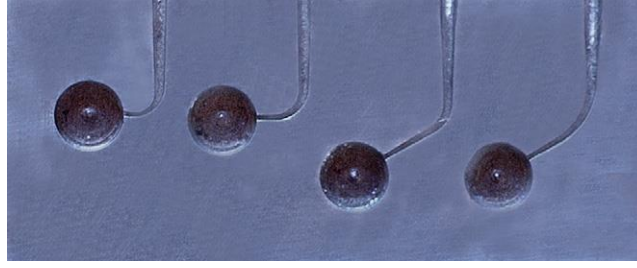
Şekil 12. Test edilecek kök kanal eğesinin apikal çap ve konisitite değerine uygun olarak hazırlanmış metal yapay kanallar (Plotino et al., 2009)
