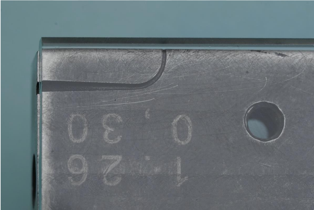
Şekil 21. Çalışmamızda kullanılan paslanmaz çelik kanalın görüntüsü.
