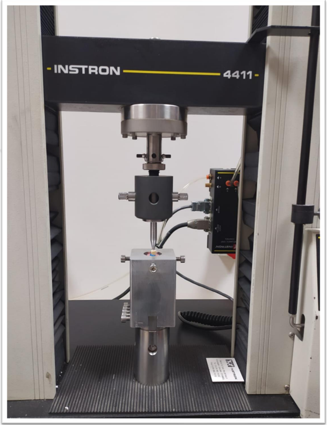
Resim 17. Kırılma deneyinde kullanılan universal test cihazı
