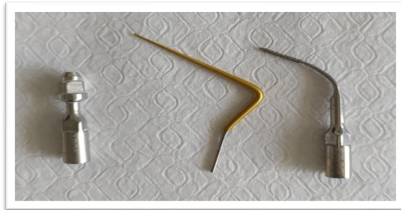
Resim 3. 180° açılı eęe tutucu (EMS, Sybron Endo, Nyon, İsviçre) ve ultrasonik uçlar (EMS, Sybron Endo, İsviçre)
