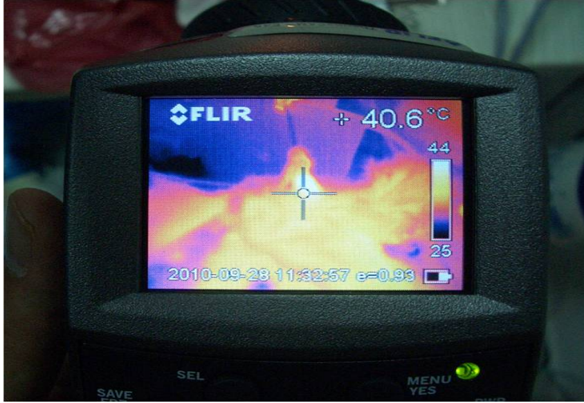
Şekil 3.8. İntرالuminal laparoskopun oluşturduğu ısının bağırsak duvarından yayılımının termal kamera ölçümündeki ekran görüntüsü.
