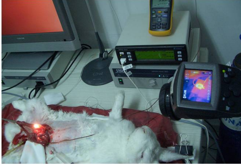
Şekil 3.7. Termal kamera ile intraluminal ısının yayılımının ölçümü.
