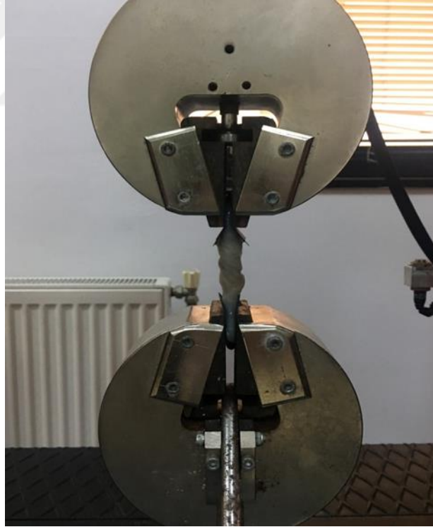
Şekil 3.1. Laboratuvarımızdaki çekme testi düzeneği ve numunenin yerleştirilmiş örneği
