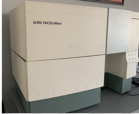
Resim 6: BD FACS Calibur akım sitometri cihazı
