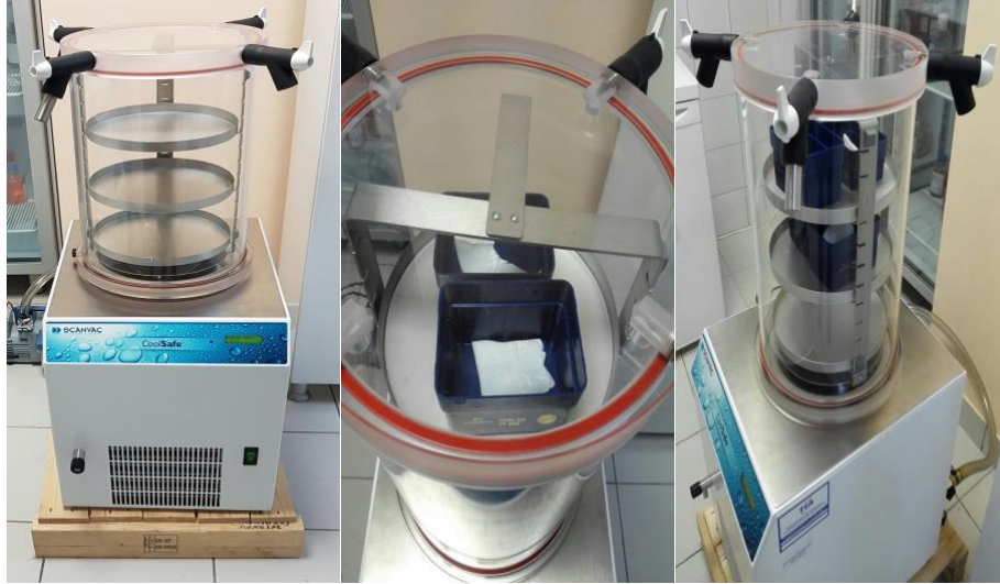
RESİM 6: LIYOFİLİZASYON İŞLEMİ İÇİN KULLANILAN LIYOFİLİZATÖR. SAĞ İKİ RESİMDE LIYOFİLİZASYON İŞLEMİ GÖRÜLMEKTE
