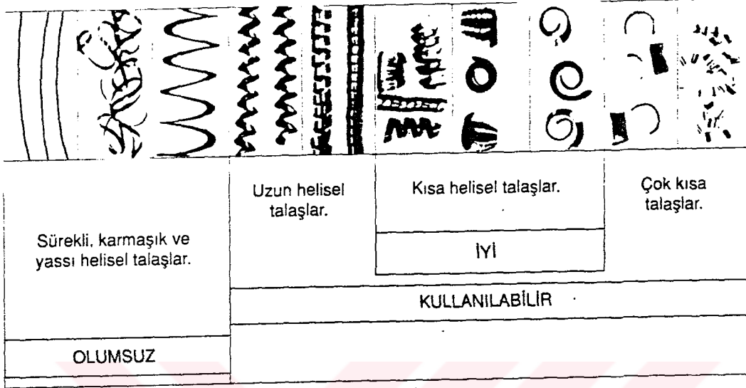
Şekil 2.5 Talaş şekilleri ve işlenebilirlik etkisi.
