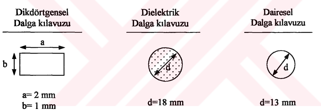
Şekil 4.5. Prob içinde kullanılan dalgakılavuzu tipleri
