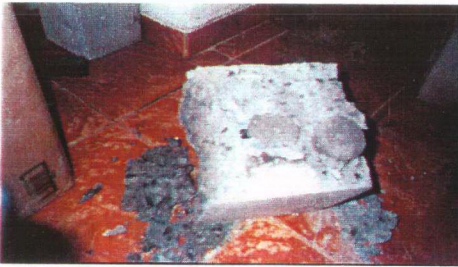
Şekil 6.5. Doldurulan harcın kırılmadan sonra bile bütünlüğünü bozmasına örnek
