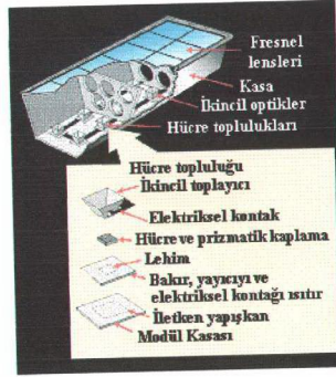
Şekil 6.10. Yoğunlaştırılmış fotovoltaik hücrenin kesiti.
