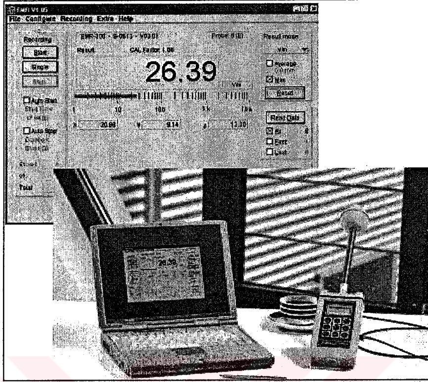
Şekil 4.6. Ölçüm sonuçlarının ölçüm cihazından bilgisayara aktarılması
