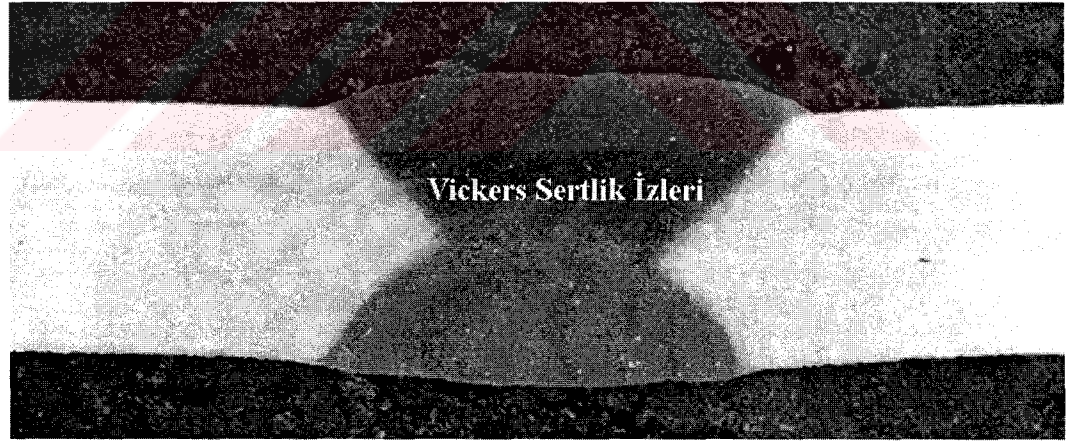
Şekil 6.22.- Mikrosertlik taraması yapılmış bir deney numunesinin makro görüntüsü.
