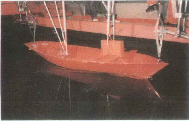
Foto A.3. V_s = 5 Knot, v_m = 1,412 m/s karşıt hızda model direnç deneyi ( WL 3 )
