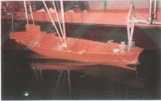
Foto A.2. V_s = 5 Knot, v_m = 1,412 m/s karşıt hızda tornistan deneyi ( WL 3 )
