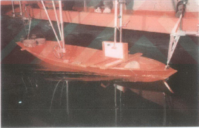
Foto A.4. V_s = 5 Knot, v_m = 1,412 m/s karşıt hızda model direnç deneyi ( WL 5 )
