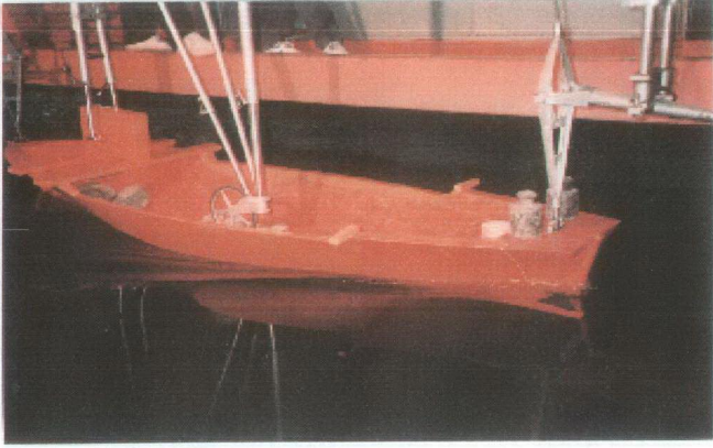
Foto A.1. V_s = 4 Knot, v_m = 1,128 m/s karşıt hızda tornistan deneyi ( WL 3 )
