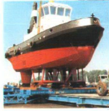
Şekil 1.8. Sikloidal pervane takılmış bir römorkör.
