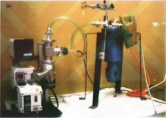
Şekil 6. 12 (a) ITC 502 Sıcaklık Kontrolü (b) Kreostat ve Vakum Pompası.
