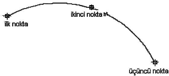
Şekil 4.10 Üç nokta ile yay çizimi
