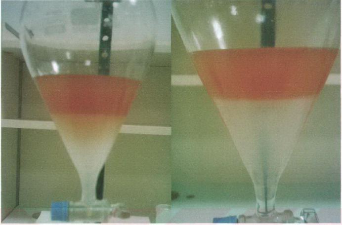
Şekil 6.2.3.Esterin Su ile Yıkınması
