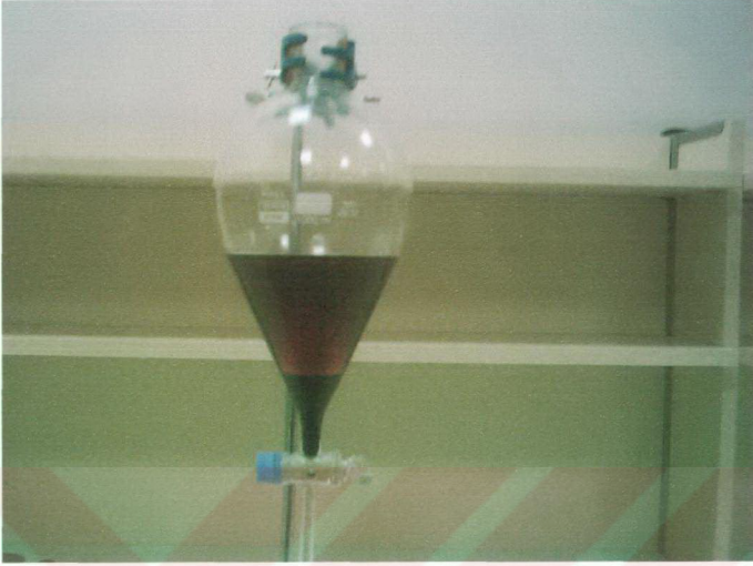
Şekil 6.2.2. Dinlendirme Kabındaki Faz Ayrışımı
