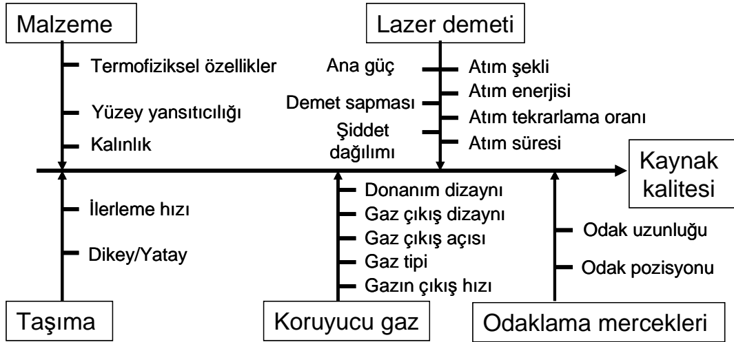
Şekil 3.10: Atımlı lazer kaynağı kalitesini etkileyen parametreleri gösteren parametre diyagramı [71].
