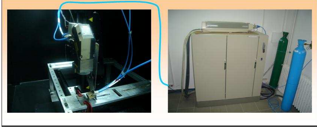
Şekil 4.1: Deneysel çalışmalarda kullanılan Nd:YAG lazer sistemi: güç ünitesi, lazer kovuğu ve odaklama ünitesi (LATARUM).
