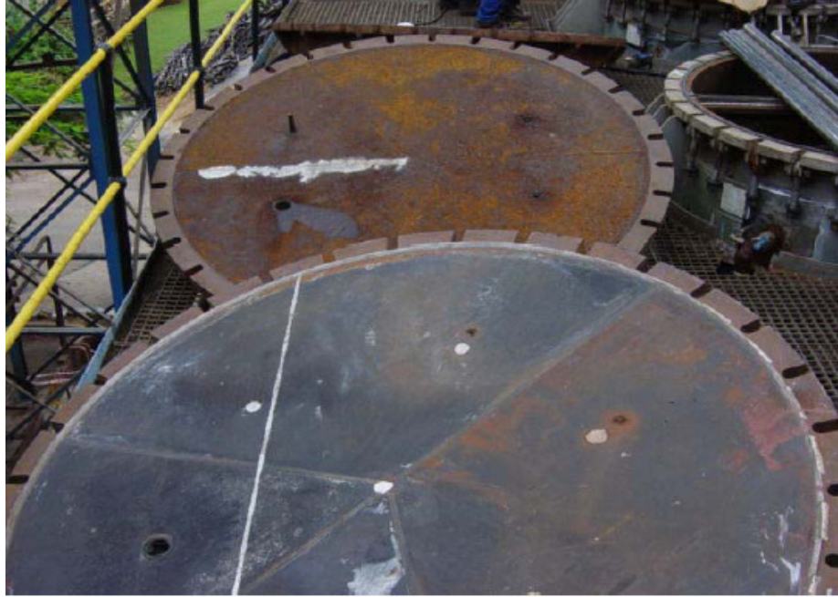
Şekil 3.20: Haşlama şerbet ısıtıcı kapağı, 3Cr12 çeliğine karşı karbonlu çeliğin durumu (NN 2007).
