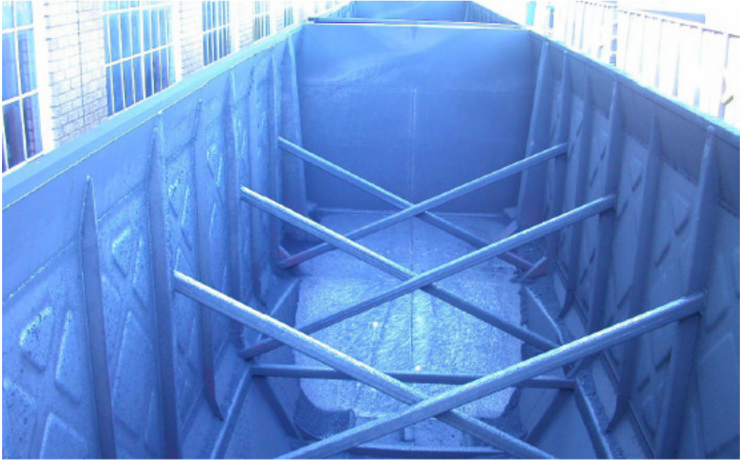
Şekil 3.9: 82 tonluk CCL Jumbo kömür vagonu iç kısımlarının görünüşü (NN 2007).
