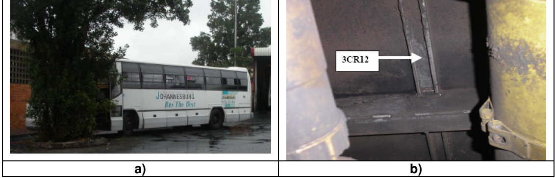
Şekil 3.13: a) 2004'de üretilmiş TFM otobüsü, b) Yaklaşık olarak 10 yıllık bir otobüsün altındaki 3Cr12 karoseri destek elemanı (NN 2007).
