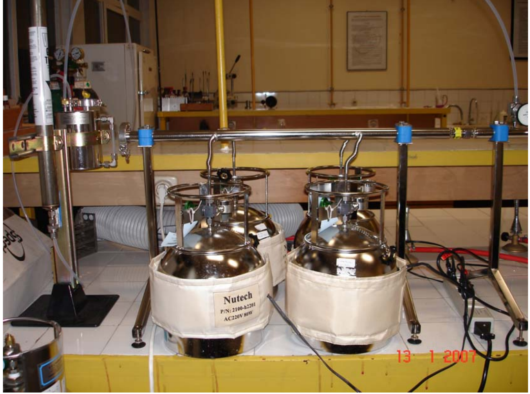
Şekil 3.6: Kanister temizleme sistemi
