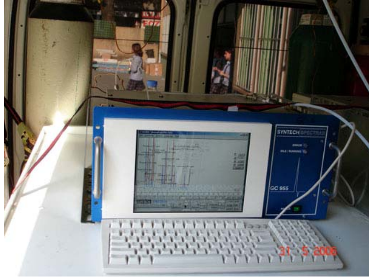
Şekil 3.4: İç ortam aktif UOB örneklemesinde kullanılan on-line gaz kromatografisi
