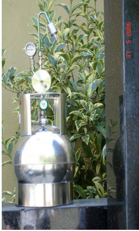
Şekil 3.5: Kanister ve kanister başlığının elemanları
