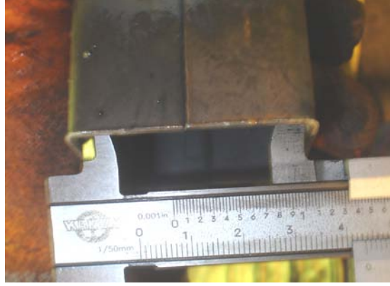
Şekil 6.4: Kutu profilden ölçüm alımı
