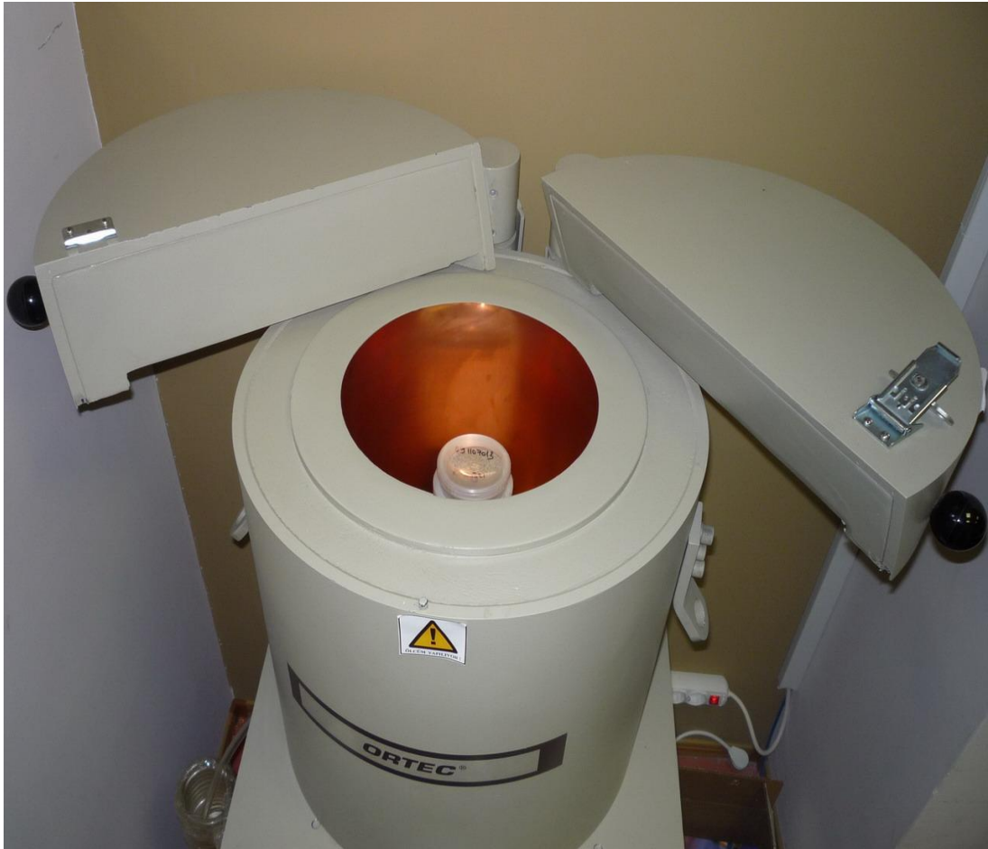
Şekil 3.8: Kocaeli Üniversitesi Fizik Bölümü, Nükleer Fizik Araştırma Laboratuvarında bulunan HPGe Gama Işın dedektörü.
