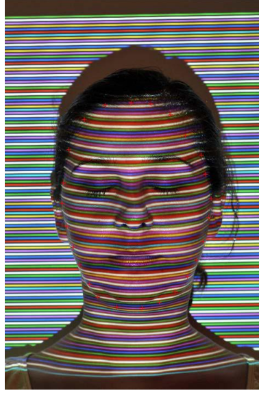
Şekil 3.7: Renk uzayı ayrışımı yaklaşımında kullanılan renkli örüntünün yüz bölgesine yansıtılmış durumu
