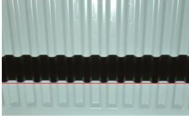
Şekil 2.1: Yapılandırılmış ışık kaynağı ile tarama mantığı, 3-B yüzeye projektör ile yansıtılan düz siyah çizginin, projektöre göre farklı bir açıdan bakıldığında görüntüsü.
