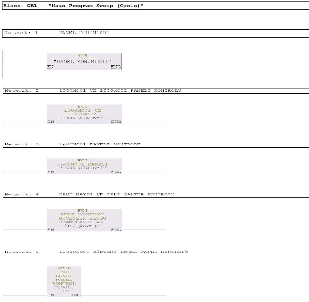
Şekil 6.9: 1300 Grubu ve 1600 Grubunun OB1 yönetici bloğunda çağırılması
