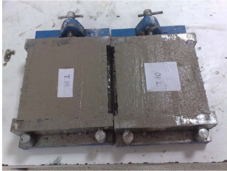
Şekil 3.8: Kalıba yeni dökülmüş numuneler
