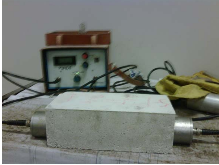
Şekil 3.12: Ultra ses deneyi
