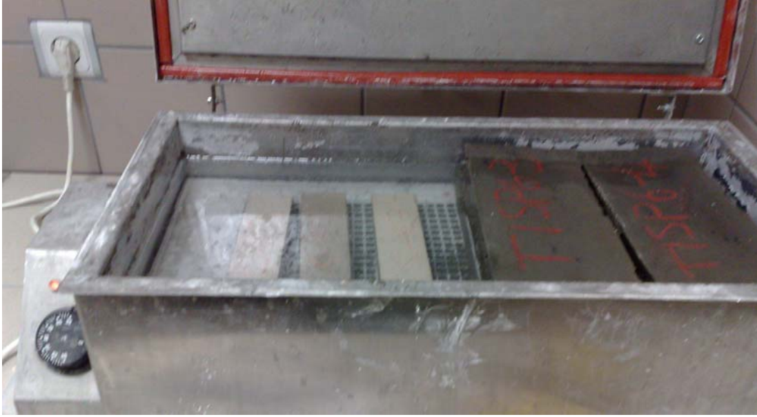
Şekil 3.9: Hızlı küre bırakılmış numuneler
