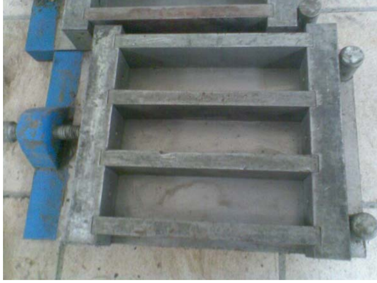
Şekil 3.3: 40x40x160 mm çelik kalıp
