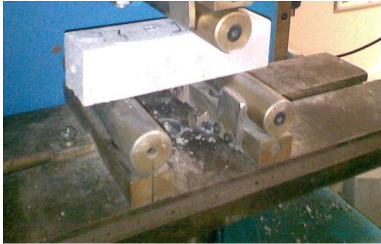
Şekil 3.11: Eğilmede çekme dayanımı deneyi
