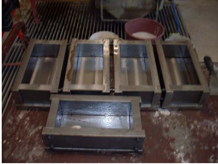
Şekil 3.4: 105x225x75 mm çelik kalıp
