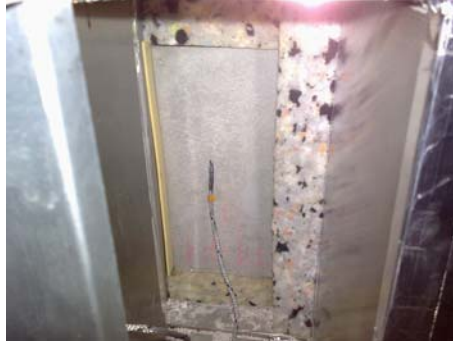
Şekil 3.14: Isıl iletkenlik deney numunesi ve termokupullar
