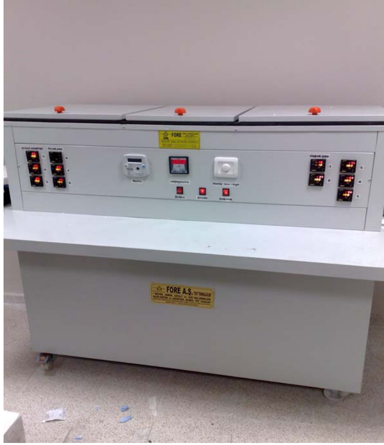
Şekil 3.13: Isıl iletkenlik deney cihazı
