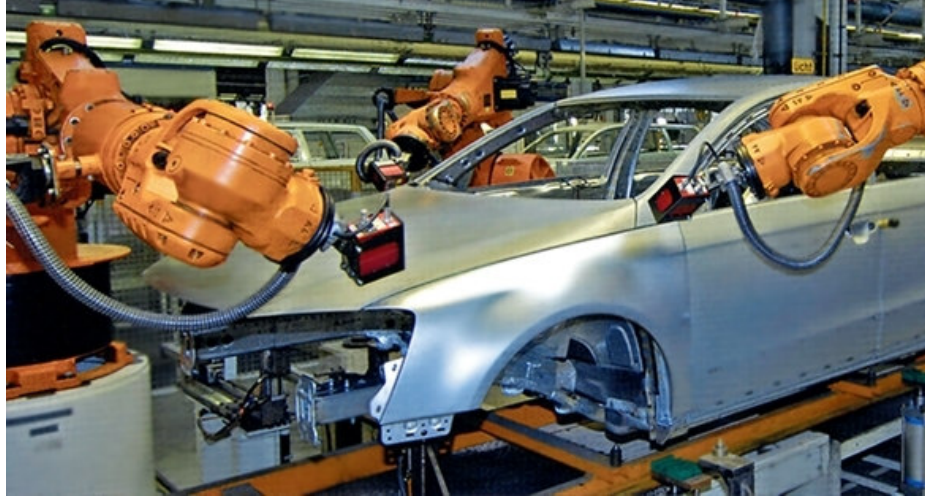
Şekil 2.5: Kamera tabanlı robotik ölçüm istasyonu
