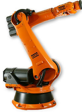
Şekil 3.1: Seri kol yapısına sahip Kuka marka bir endüstriyel robot
