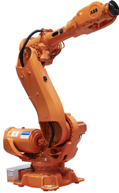
Şekil 3.7: Mafsal yapıya sahip ABB marka bir endüstriyel robot
