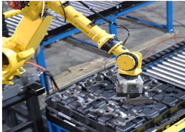
Şekil 2.6: Robotik al-bırak uygulaması
