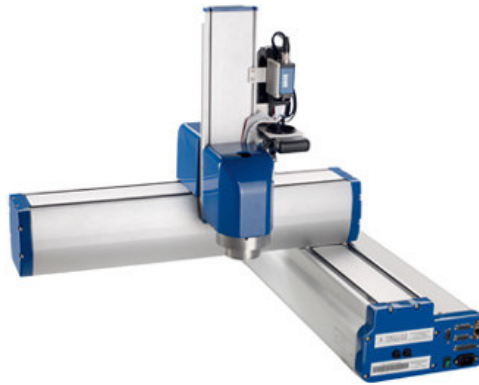
Şekil 3.3: Kartezyen yapıya sahip Schunk marka bir endüstriyel robot
