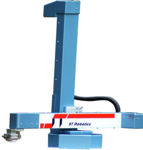
Şekil 3.4: Silindirik yapıya sahip ST Robotics marka bir endüstriyel robot
