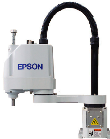
Şekil 3.6: SCARA yapıya sahip EPSON marka bir endüstriyel robot
