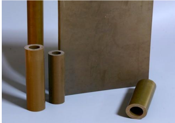
Şekil 2.7: Bronz alaşımlı PTFE ile üretilmiş olan parçalar [6]
