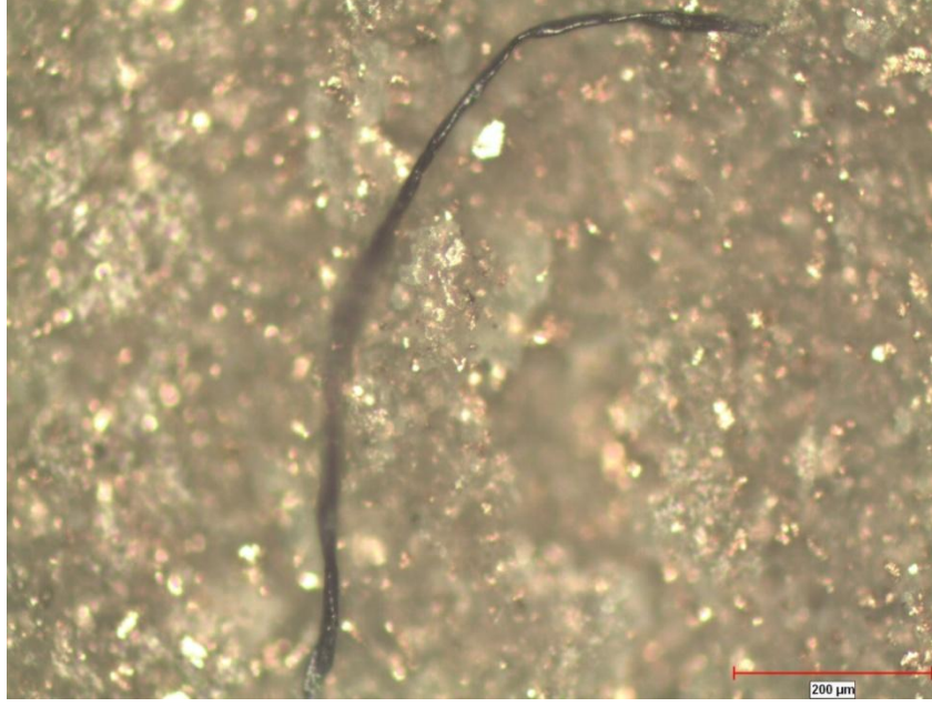
Şekil 4.21: 23°C’de 6 mm kalınlığına sahip %40 katkı oranlı Bronz-PTFE’nin kırılma yüzeyi
