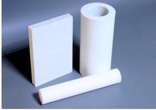
Şekil 2.6: Cam elyaf alaşımlı PTFE ile üretilmiş olan parçalar [6]
