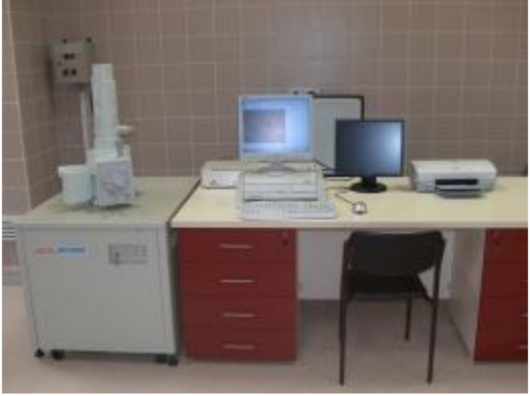
Şekil 3.4: JEOL JSM-6060 taramalı elektron mikroskobu (TEM)
