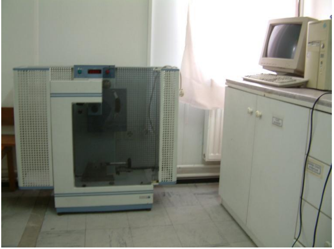
Şekil 3.3: Ceast 6545 enstramente edilmiş çentik darbe cihazı
