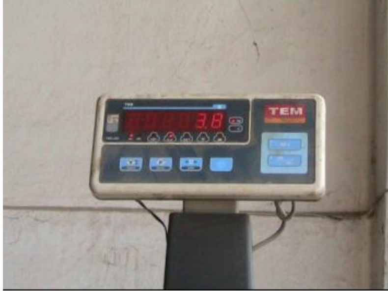
Şekil 4.16: Bünyan cinsi halı numunesinin yıkanmış ıslak halde ağırlığı.
