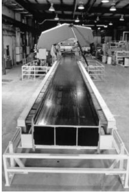
Şekil 4.5: Çift gövdeli hibrit lifli pultruziyon kesit.
