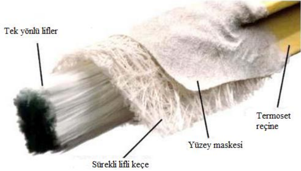
Şekil 4.9: Pultrüzyon yöntemi ile üretilmiş lifli polimer profilin kesiti.
