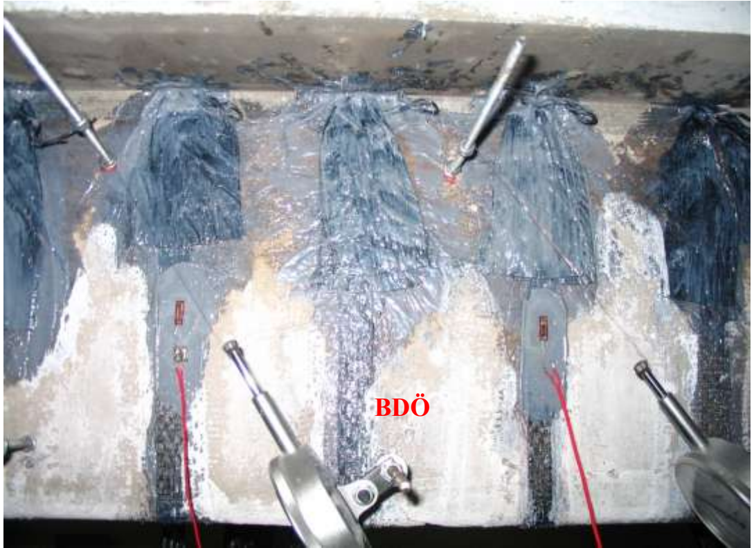
Şekil 3.19 Birim deformasyon ölçerlerin (BDÖ) yerleřim řekli
