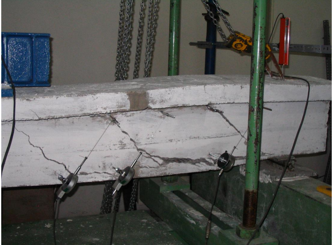
Şekil 4.1: BV numunesinde göçmenin olduğu ana çatlağın resmi
