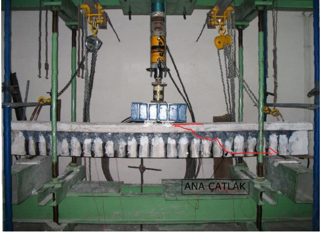
Şekil 4.73: BHA numunesi çatlak dağılımı
