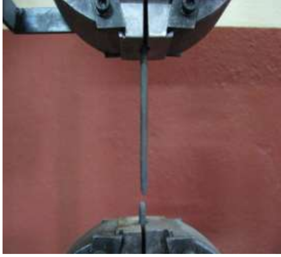
Şekil 3.14: İnce çelik çubuğu çekme için çekme deneyi düzeneği
