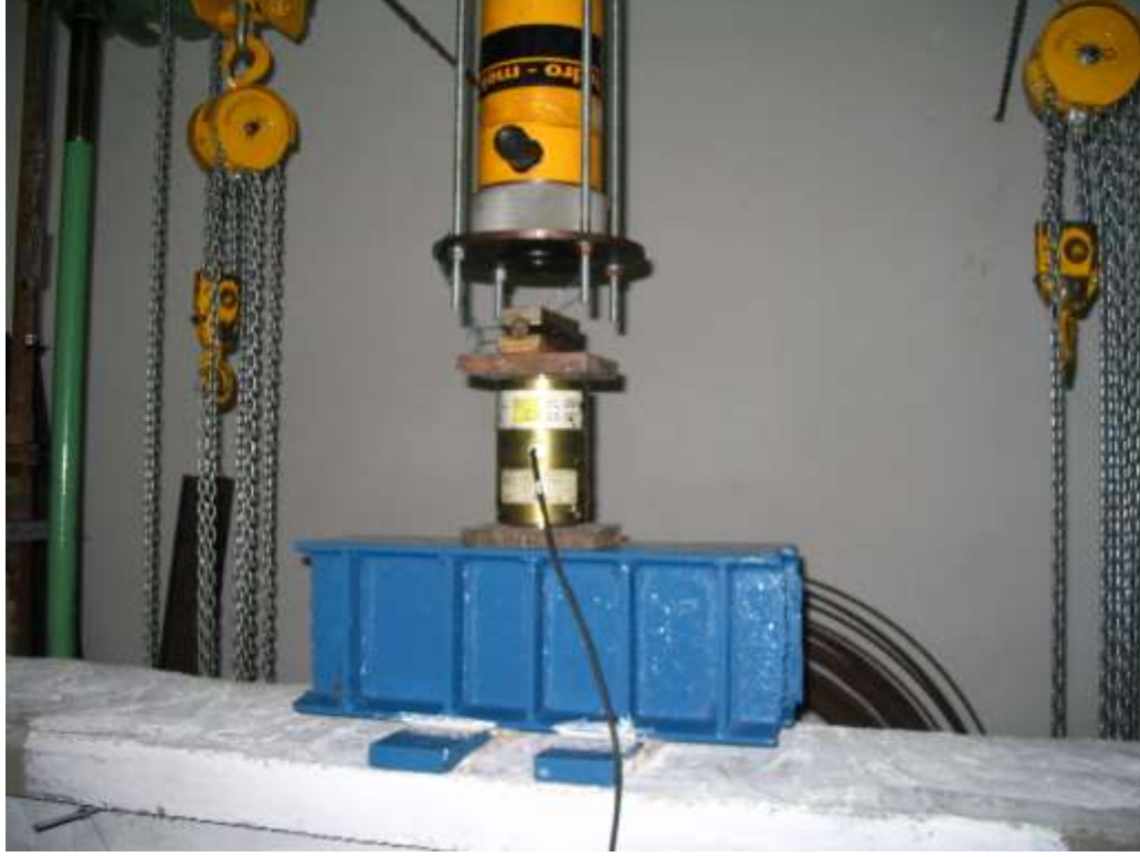
Şekil 3.16: Deney numunelerini yükleme sistemi
