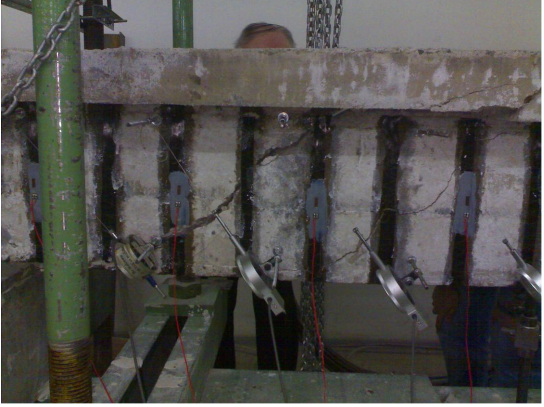
Şekil 4.12: BHU numunesinde göçmenin olduğu ana çatlağın resmi
