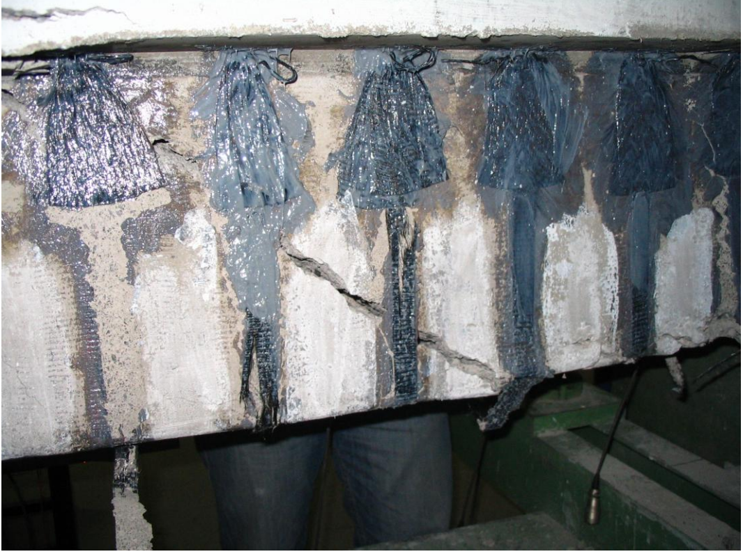
Şekil 4.6: BCA numunesinde ankraj çivisi ve CFRP şeritlerin kopması
