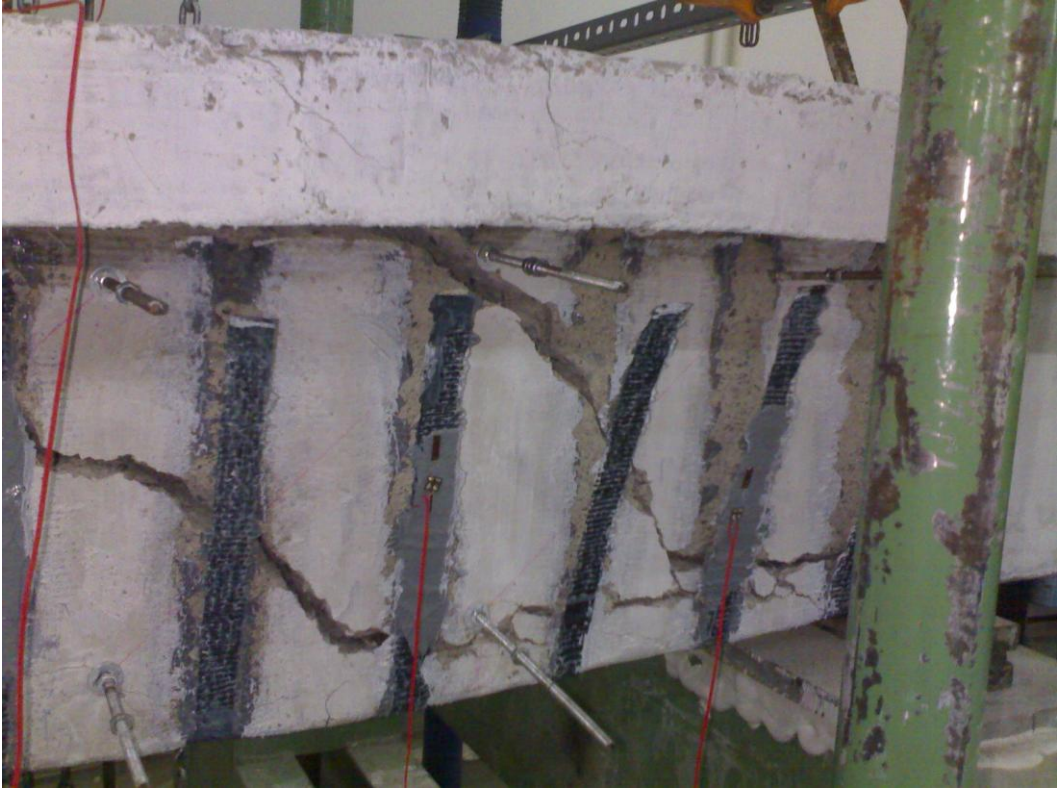
Şekil 4.2: BV numunesinde göçmenin oluştuğu ana çatlağın resmi
