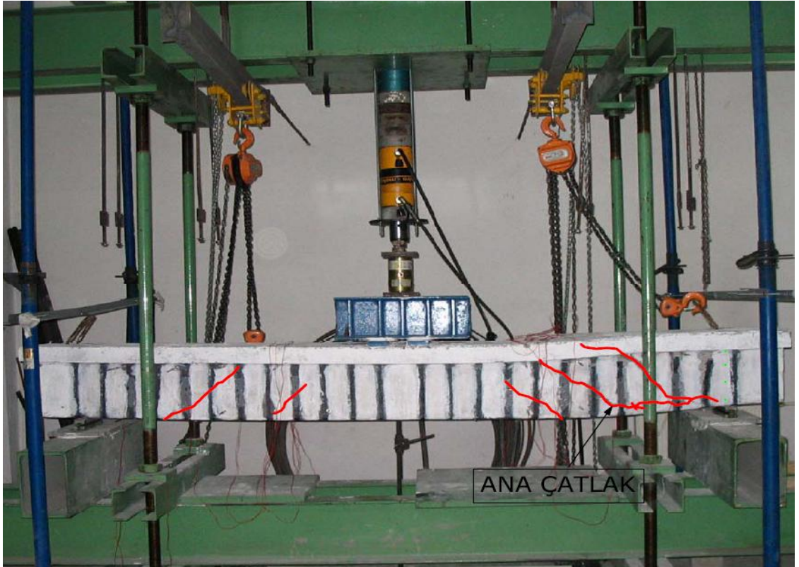
Şekil 4.18: BCU numunesi çatlak dağılımı
