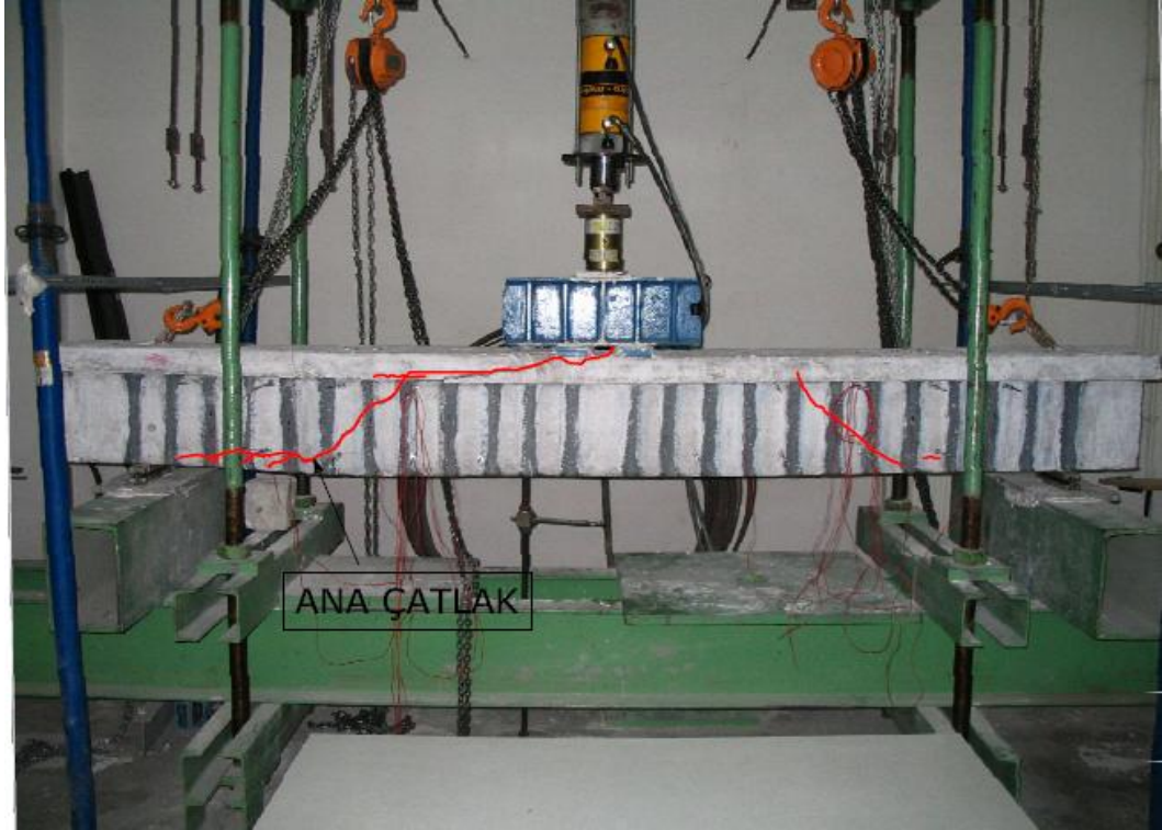
Şekil 4.40: BGU numunesi çatlak dağılımı
