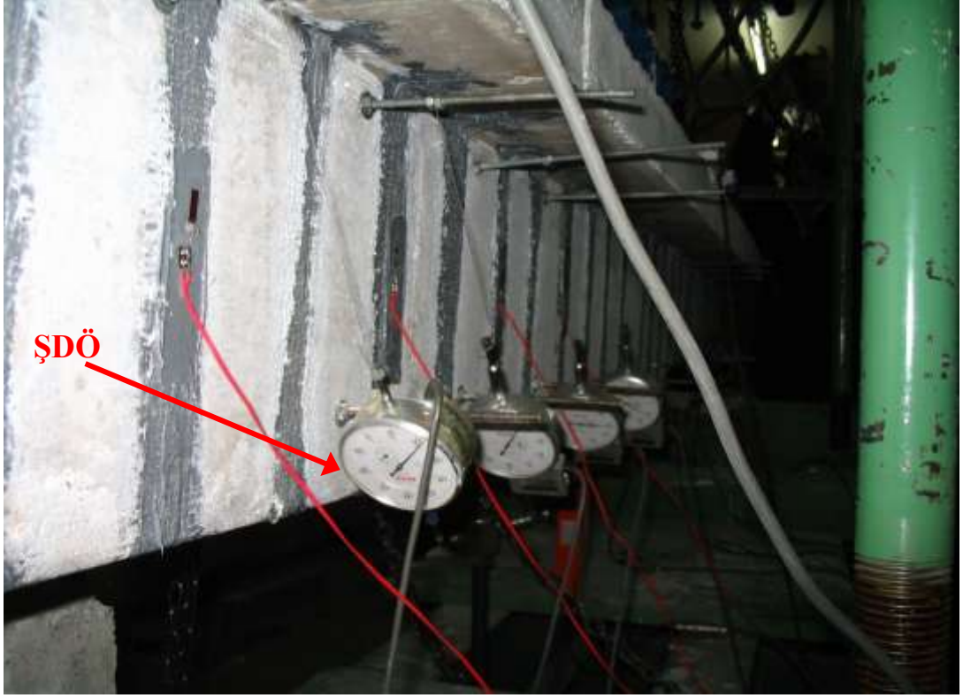
Şekil 3.18: Şekil deęiřtirme ölçerlerin (ŞDÖ) yerleřim řekli
