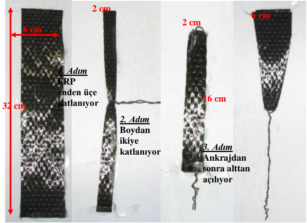
Şekil 3.10: Ankraj çivilerinin hazırlanması
