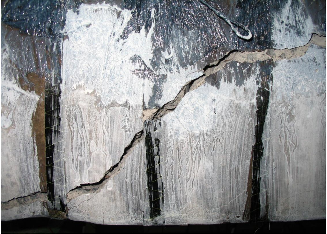
Şekil 5.10: BHA numunesinde Hi-CFRP şeritlerin kopması
