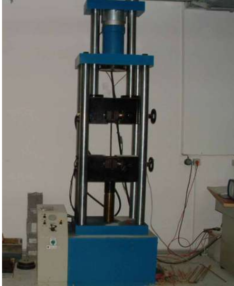
Şekil 3.15: Çelik çekme deneyi ve aparatı
