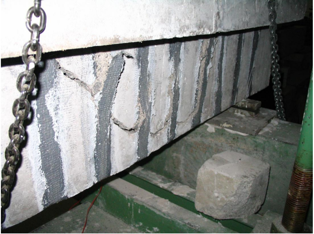
Şekil 4.6: BCA numunesinde ankraj çivisi ve CFRP şeritlerin kopması
