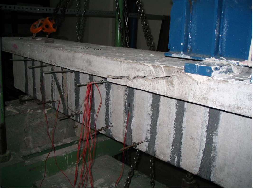
Şekil 4.8: BGU numunesinde göçmenin olduğu ana çatlağın resmi
