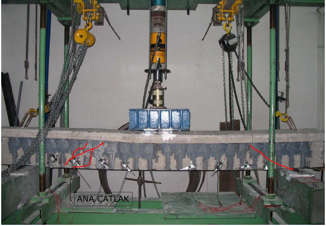
Şekil 4.51: BGA numunesi çatlak dağılımı
