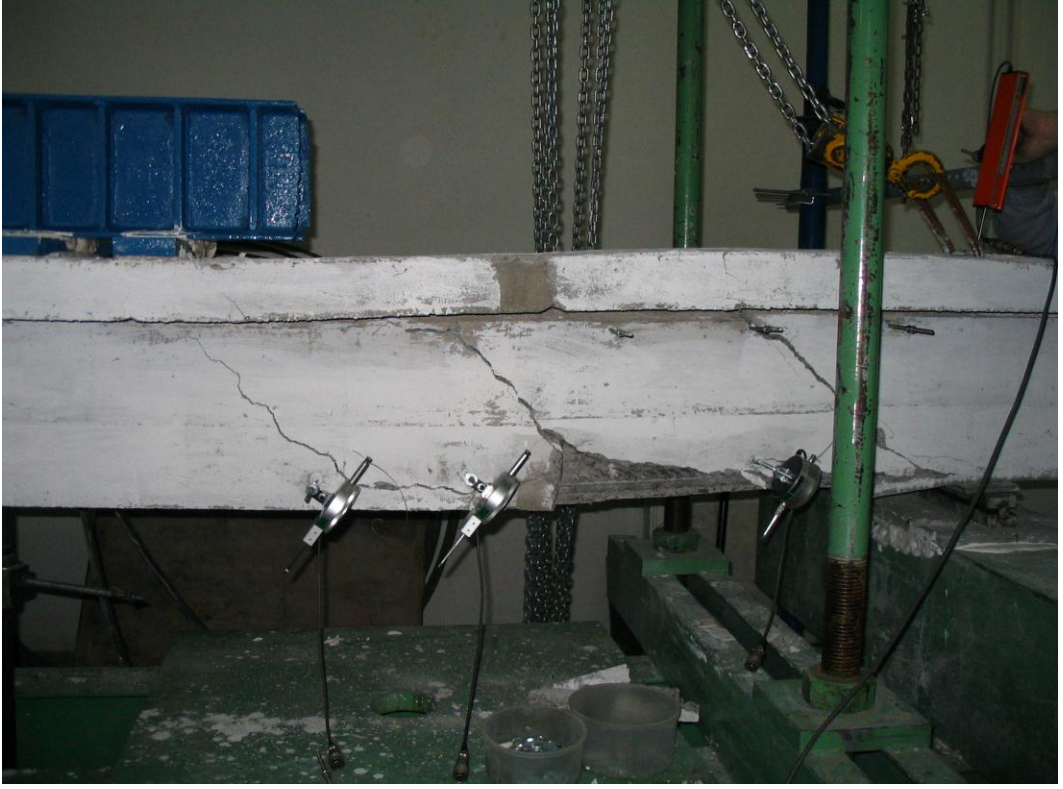
Şekil 4.2: BV numunesinde göçmenin oluştuğu ana çatlağın resmi
