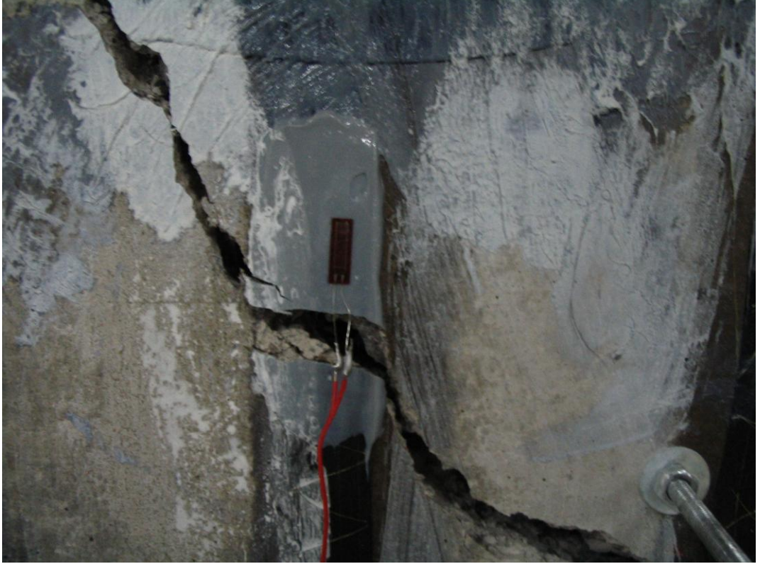
Şekil 4.13: BHA numunesinde Hi-CFRP şeritlerin kopması
