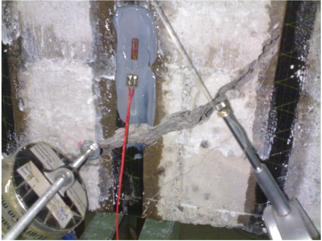
Şekil 4.10: BGA numunesinde göçmenin olduğu ana çatlağın resmi
