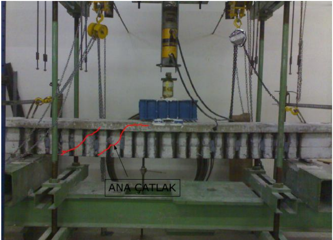
Şekil 4.62: BHU numunesi çatlak dağılımı
