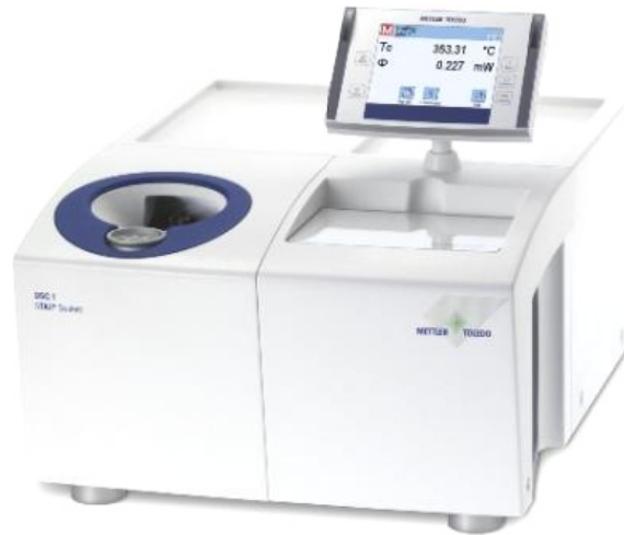
Şekil 3.5: Mettler Toledo DSC1 analiz cihazı [35]
