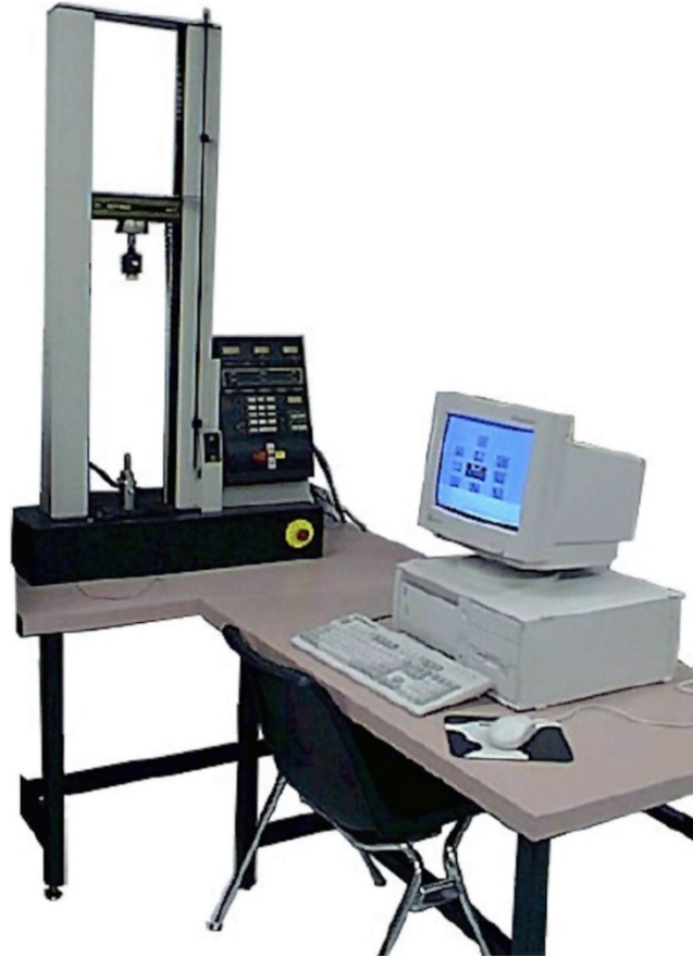
Şekil 3.3: Instron 4411 universal elektromekanik test cihazı [27]
