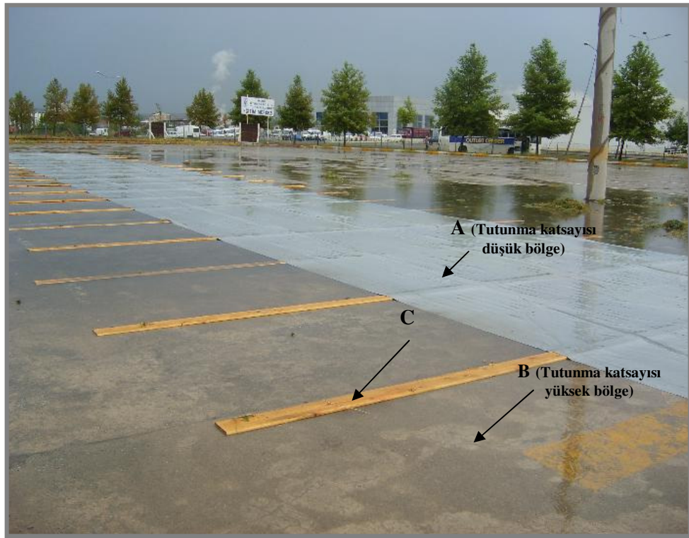
Şekil 4.1: Pürüzlü ABS test yolu (A: Lastik branda ile örtülmüş test yolu, B: Örtüsüz beton yol, C: Tahta kalaslar)
