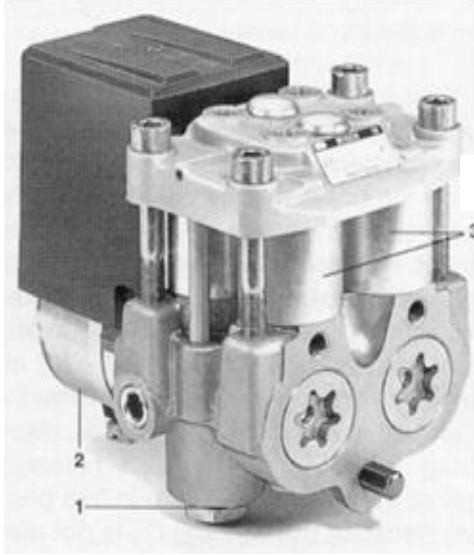
1. Akümülatör 2. Geri dönüş pompası 3. Selenoid valf grubu
