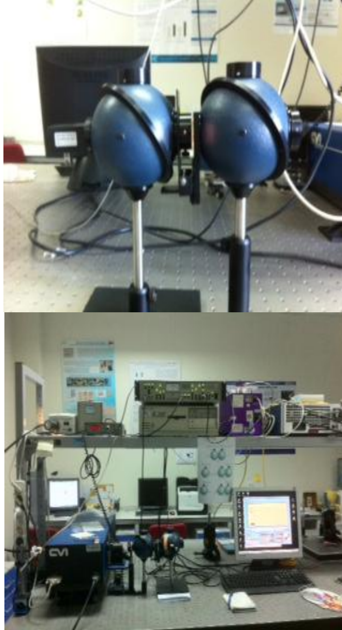
Şekil 2.2. Boğaziçi Üniversitesi Biyomedikal Mühendisliği Enstitüsü Biyofotonik Laboratuvarı’nda bulunan, transmittans ve reflektans ölçümlerinin yapıldığı çift küreli sistem.
