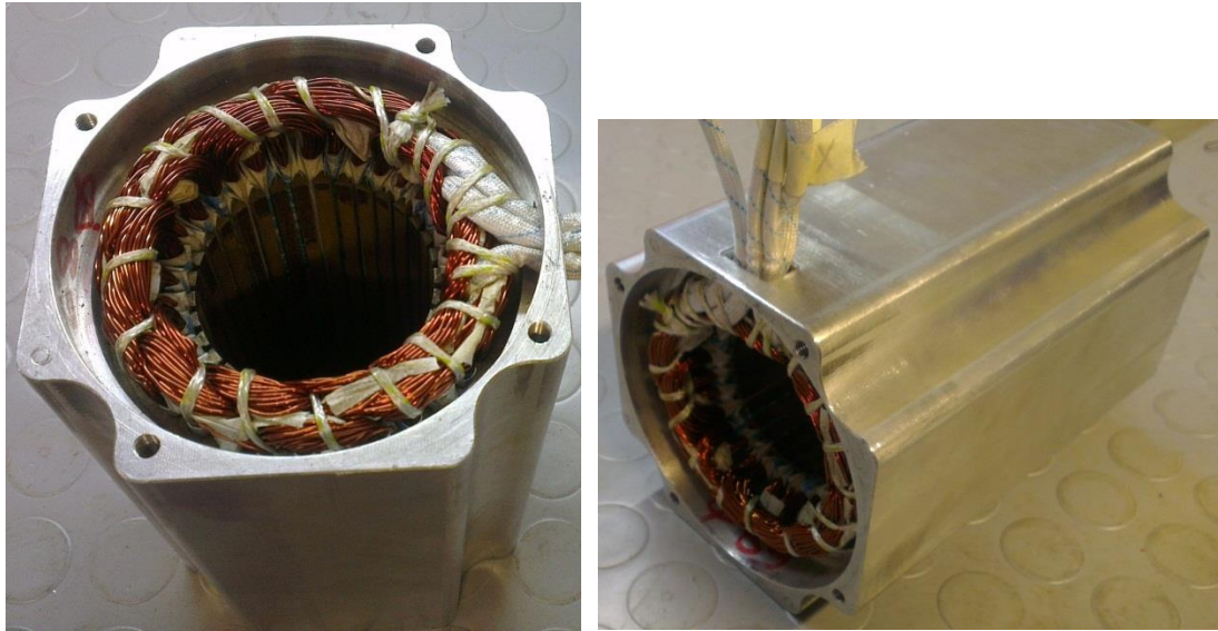
Şekil 6.5. Statora sargıların yerleştirilmiş hali
