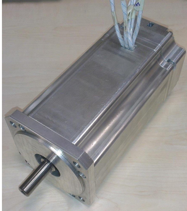
Şekil 6.7. Montajı tamamlanmış servomotor
