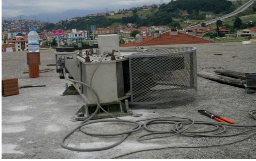
Şekil 3.11. Dinamik sarsıcı (Halidere Binaları, Kocaeli, 2011)
