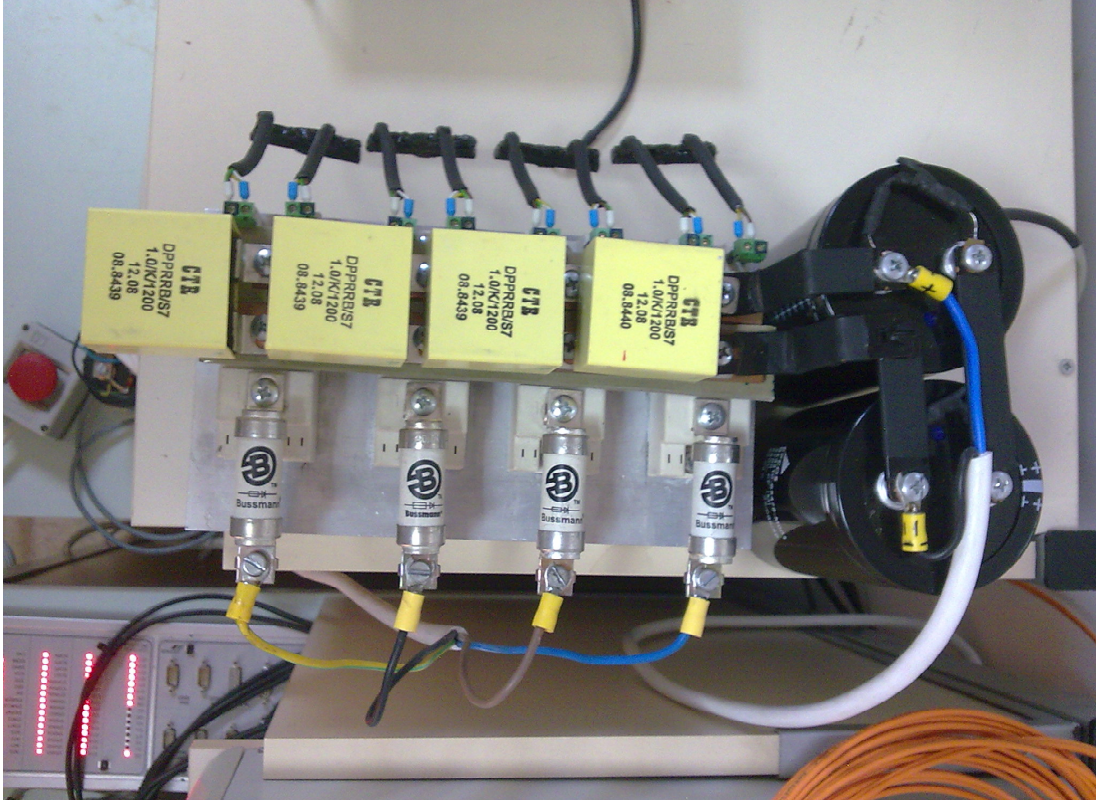
Şekil 5.13. 3 faz 4 kollu 4 telli FV sisteminin gerçekleştirilen güç devresi fotoğrafı
