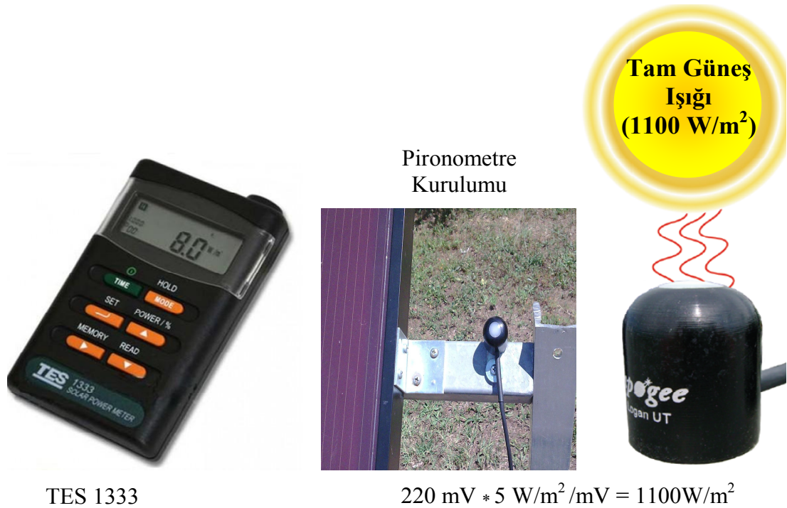
Şekil 5.14. Dijital güneş enerjisi ölçeri (TES-1333) ve Apogee pironometre (SP-110) fotoğrafları
