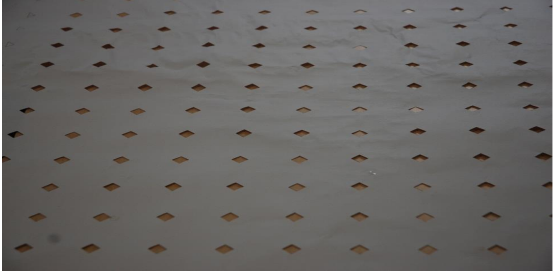
Şekil 3.7. Homografi için kullanılan kalibrasyon kâğıdı
