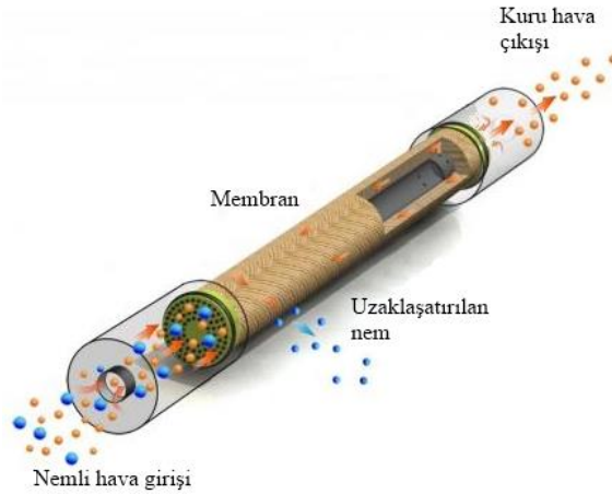
Şekil 1.8. Membran kurutucu çalışma sistemi
